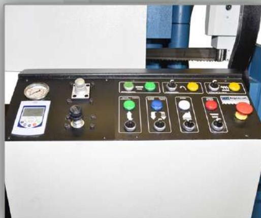
● Tablero electrónico con regulador de cortes.
